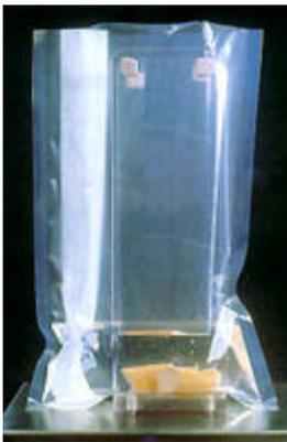
专利的 BagFilter®和 BagPage® 具有极为坚固的塑料袋，内置有滤膜(BagFilter® P 和 S 为侧边滤膜，BagPage®为全滤膜)。在拍打均质完成后，固体残渣纤维将被滤膜隔离和保留，从而使样品溶液被过滤，可直接取样分析。
