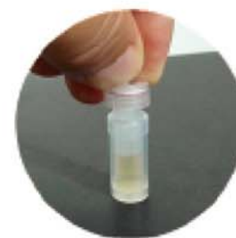
第2步：将内滤管插入外管底部，过滤完成！
