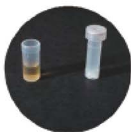
第1步：在外管中加入待过滤溶液
